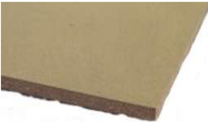
**Figure 19 :** Panneaux agglomérés à base de la jacinthe d'eau
